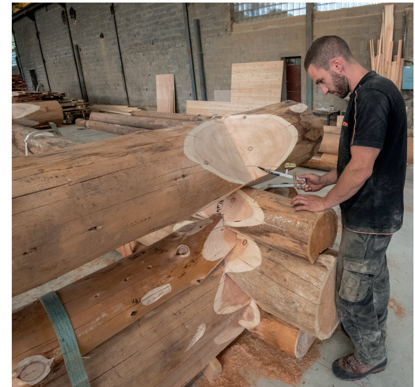
Le compas-trusquin (ou French Scriber) a été conçu par l'École de la Fuste de la Combe Noire de Thierry Houdart.
